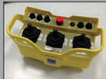
È dotato di joystick, interruttori e pulsante di emergenza, per la movimentazione delle articolazioni. Per facilitare l'uso della macchina, sul trasmettitore è stato inserito un interruttore con doppia velocità: lenta e veloce.
