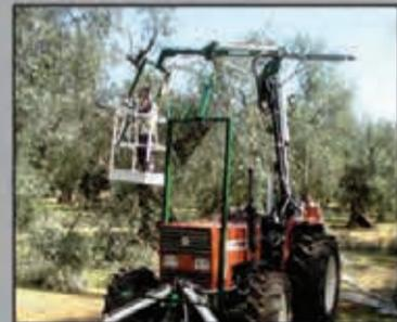
Per facilitare la potatura delle piante e ridurre i rischi di infortunio, mediante apposito kit, può essere montato un cestello di sollevamento, in sostituzione del pettine bacchiante.
