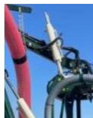
Il sistema permette di inclinare il gruppo di raccolta, in presenza di pali storti.
