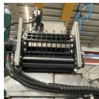
Applicato sopra la vasca di raccolta, consente di ottenere un prodotto perfettamente pulito. E' composto da un nastro trasportatore modulare a griglia, a velocità regolabile, ed un vaglio vibrante ad aste multiple per l'eliminazione delle impurità. Il nastro è provvisto di inversore di rotazione.
